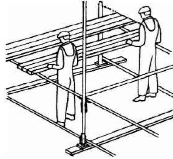
Піднесення та укладання щитів настилу
