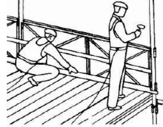
Піднесення та установка елементів огорожі
